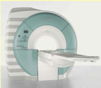
Questo magnete è di per sé estremamente costoso. Necessita inoltre di un sistema di raffreddamento ad elio anch'esso molto costoso in termini di consumo di energia elettrica. Questo tipo di magnete permette di ottenere sia una intensità di campo molto elevata che una ottima stabilità, caratteristiche fondamentali e determinanti per ottenere il massimo di nitidezza e di dettaglio delle immagini e quindi massima precisione diagnostica.
